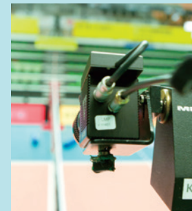
6 네트 위에 고정된 핀 카메라다. 경기 전 네트를 거는 기둥에 폴을 달아 고정된 후 화각을 잡아준다. 선수들의 네트터치를 정확하게 잡아낸다.
