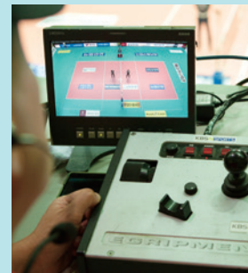
5 왼쪽 모니터는 천장 카메라에 비친 영상이다. 앞에 놓인 조종기로 카메라를 움직여 필요한 화면을 잡아낸다. 카메라의 정확한 위치는 6번 카메라 위, 천장 쪽이다. 경기 시작 전후나 자료 화면 배경으로 자주 쓰인다.
