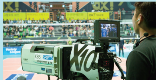
3 1층 엔드라인 뒤쪽에 있는 초고속 카메라다. 줌으로 담겨 주요 선수들의 모습을 생생하게 담아낸다. 초당 2,600프레임을 담을 수 있어 얼굴에 땀 뭉방울까지 선명하게 잡아낸다. 맞은편에도 한 대가 더 있다.
